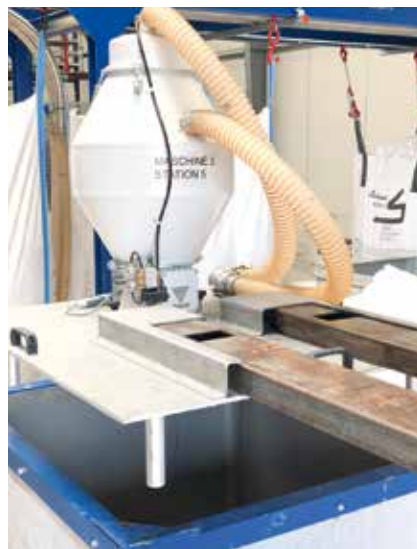
Bild 3. Deckel-Spezialanfertigung: Die Einfahrkufen und Beine (links) erlauben eine gute Handhabung bei Austausch sowie Reinigung und ein Drehflügelmelder (rechts) sorgt für eine zuverlässige Füllstandsmeldung
