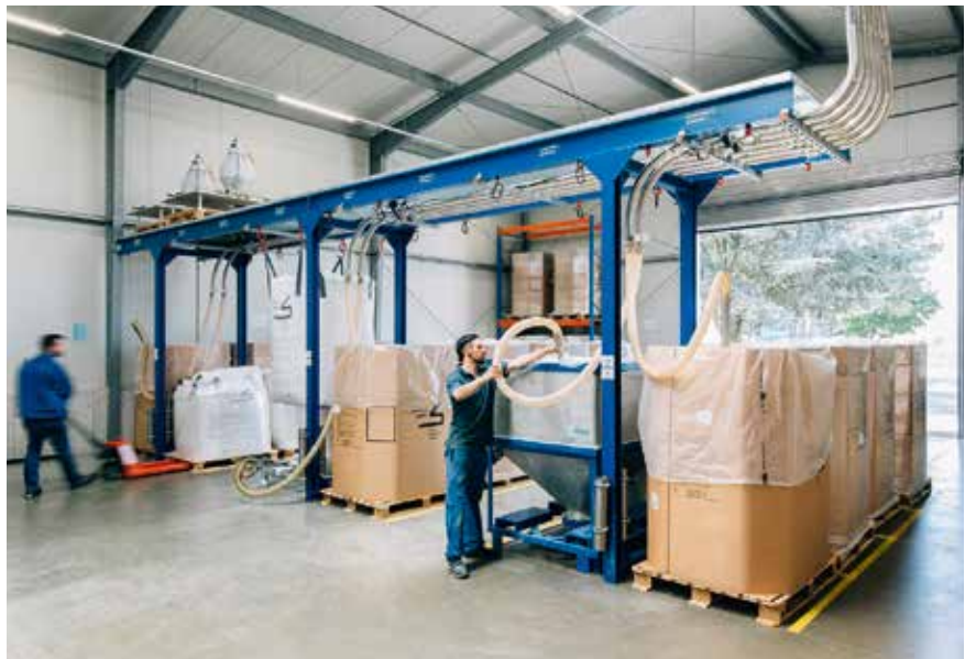
Bild 1. Rohstoff-Aufgabestation: Die Förderung der Rohstoffe erfolgt aus Gebindeformen wie z.B. Big Bag, Oktabin oder Schüttgutbehälter (© Adamski-Fotografie)
