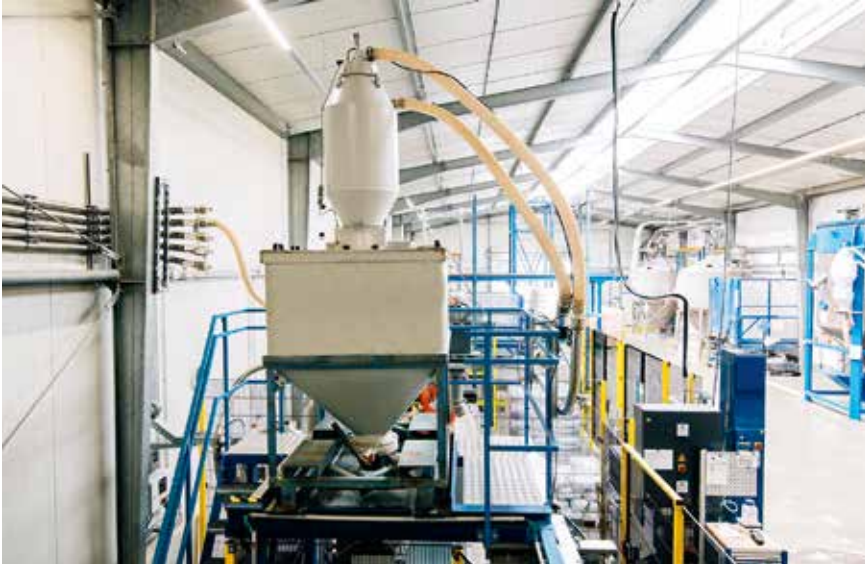
Bild 4. Vollautomatische Absackstation: Die Beschickung erfolgt wahlweise über Container mit oder ohne Spezialdeckel (© Adamski-Fotografie)
